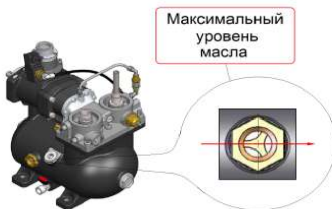
Рисунок 17 – Контроль уровня масла в компактном компрессорном модуле
