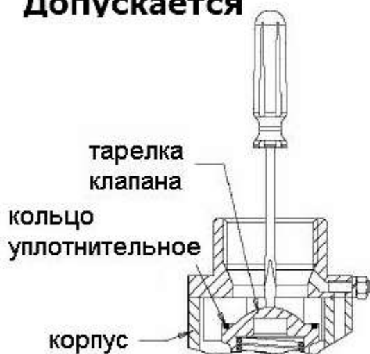
Рисунок 21 - Действия при отжати тарелки клапана
