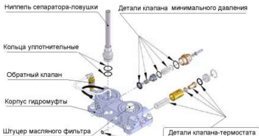
Рисунок 12 – Гидроплита, клапан-термостат и клапан минимального давления
