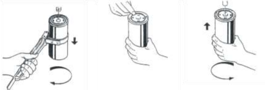
Рисунок 22 – Последовательность операций при замене фильтра масляного
